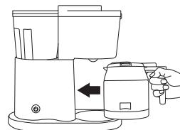
内部フィルターのしづく漏れ防止弁に保温ポットフタのコーヒー受け口が合い、口が正面に向くように保温ポットを水平に挿入します。
