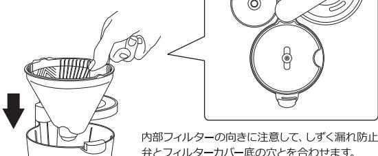
内部フィルターの向きに注意して、しづく漏れ防止弁とフィルターカバー底の穴とを合わせます。
