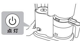
電源プラグをコンセントに差し込み、電源スイッチをオンにしてください。スタートアラームが鳴り、電源スイッチが点灯します。1分30秒間の蒸らし時間が終わるとコーヒーの滴下が始まります。
