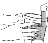
水槽タンクに水を入れて水槽タンクフタを閉じ、本体にセットしてください。
