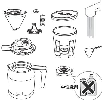
水ですすぎ洗いしてください。浄水フィルター以外のもので汚れがひどい場合は、中性洗剤を水またはぬる湯で薄め、柔らかいスポンジを使用して軽く洗ってください。その後、洗剤が残らないようにすすぎ洗いをしてください。
