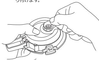
必ず、パッキンが反っている方(○)を外側にして取り付けてください。
