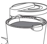
杯数分のコーヒー粉を入れ、フィルターカバーを閉めてください。コーヒーカップ1杯につき付属メジャー・スプーンすりきり1杯が目安です。
