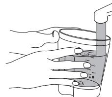
杯数分の水を水槽タンクに入れてください。水槽タンクの目盛りはコーヒーの出来上がり量を示します。
