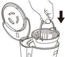
本体上部を開け、収める向きを確認しながら内部フィルターをセットします。
