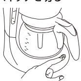
ボコボコという大きな音は抽出終了の目安です。電源スイッチを切り、コーヒーが落ちたことを確認してからガラスポットをゆっくり抜き、カップに注ぎます。
