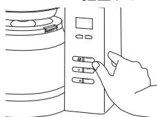
ホッパーのフタを閉め、電源ボタンを押すと緑色ランプが点滅し、しばらくしてミル挽きが始まります。ミル挽きが終わると抽出が始まり、抽出が終わるとランプが消灯します。
